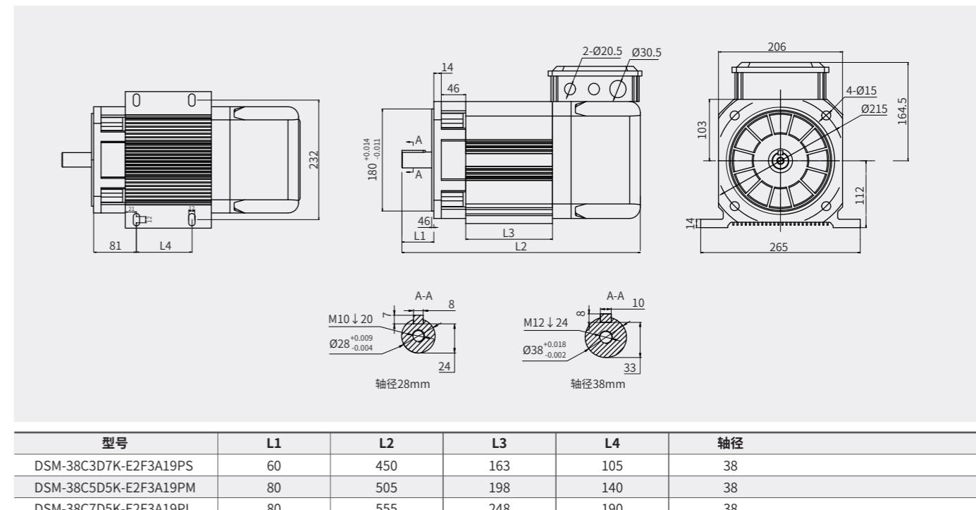
DSM电机外形尺寸
